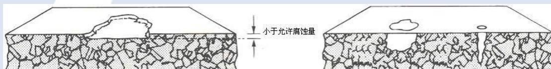
C 型蚀点---气孔型或空洞型
